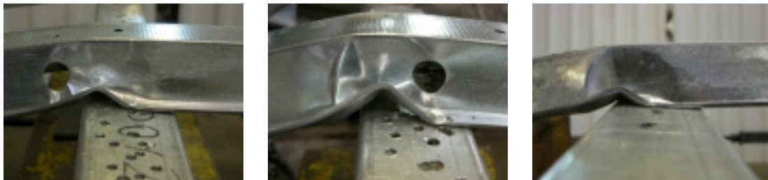
10. ábra: Hajlítási-beroppanási tönkremenetel (a) lyuk a támasz mellett, (b) lyuk a támasz felett, (c) tömör gerinc
