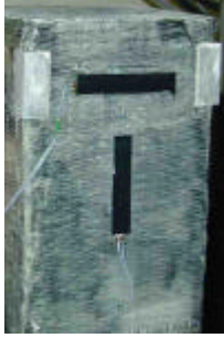
6. ábra: A felragasztott és védelemmel ellátott nyúlásméző bélyegek egy oszlopon.
